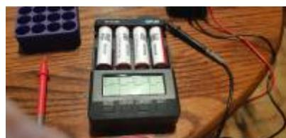
Vor dem 30-tägigen Einlagern, wird nochmals die Spannung mit dem Multimeter gemessen und dokumentiert. Nach den 30 Tagen wird dann wiederum die Spannung gemessen und dokumentiert.
