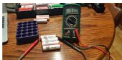
Dannach wird unser Zellen Testgerät benutzt, um die Zellen zu laden. Dafür wird die Option Refresh verwenden, um die Zellen mehrmals zu be- und entladen. Ist dies vollendet, erscheind auf dem Display FULL. Jetzt kann man direkt die Kapazität und den Innenwiderstand messen und dokumentieren.
